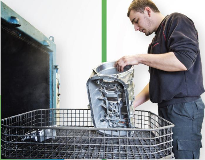
A.T.D. dispose de bancs d'essai permettant aux boîtes de vitesses de subir des tests de contrôle minutieux.
